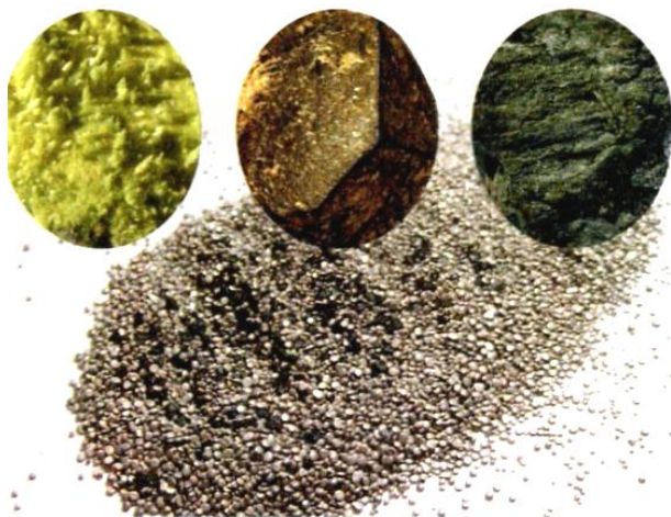
Рис. 2. Внешний вид основных компонент дымного пороха (сверху слева-направо серы, калиевой селитры и древесного угля), применяемых при его (внизу) изготовлении [8]
