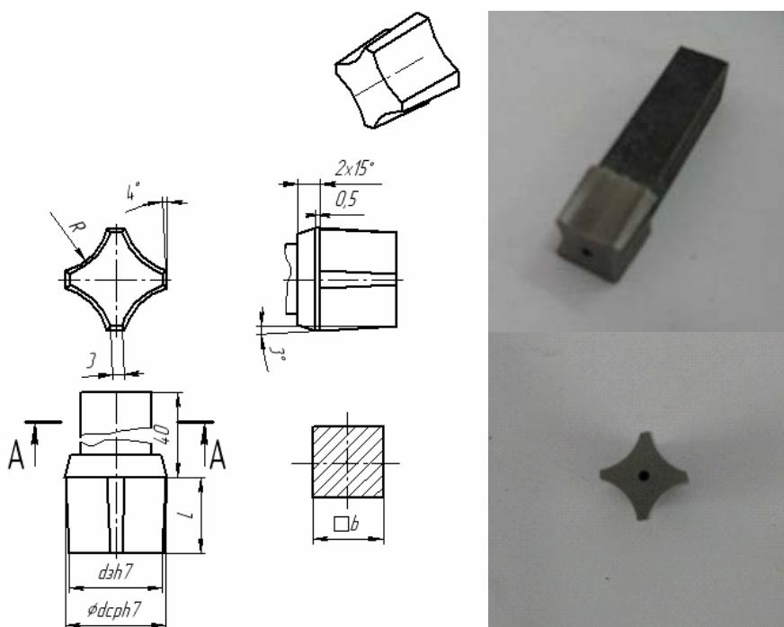
Рисунок 2 – Деформирующий инструмент для глухих отверстий
