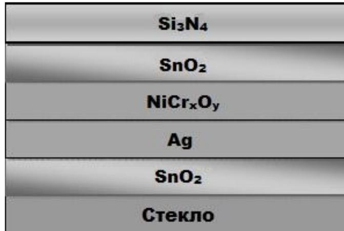
Рис. 4. Структура мягкого покрытия Е-стекла (Double Low-E):
