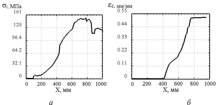
Рис. 4 – Зависимость: а – интенсивность напряжения  $\sigma_i$  от перемещения пуансона  $X$ ;
