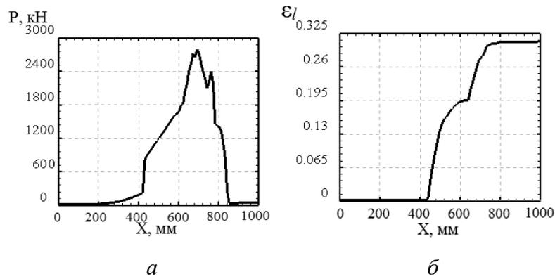
Рис. 3 – Зависимость: а – силы вытяжки  $P$  от перемещения пуансона  $X$ ;
