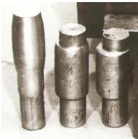
Рис. 5 – Вариант холодной штамповки со сдвигом
