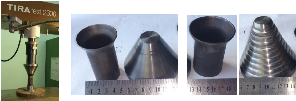
Рис. 11 – Результати експериментальних досліджень: а – пуансон спеціального профілю з вихідною заготовкою на машині TIRA test 2300, б – здеформована заготовка та традиційний пуансон, в – здеформована заготовка та пуансон спеціального профілю
