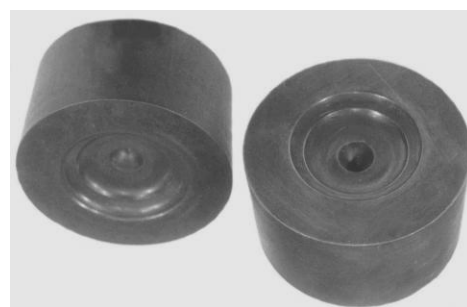
Рис. 11 – Заготовки полостей матриц для АДВ из стали Р6М5
