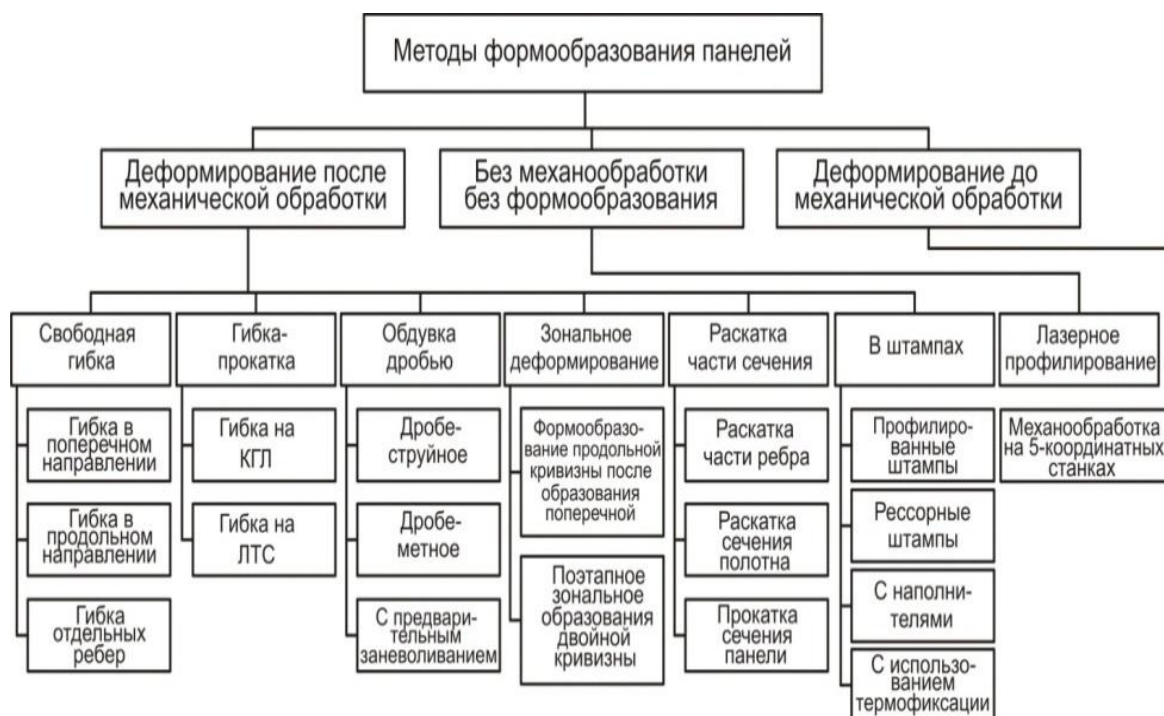
Рис. 1 – Методы формообразования профилей и монолитных панелей
