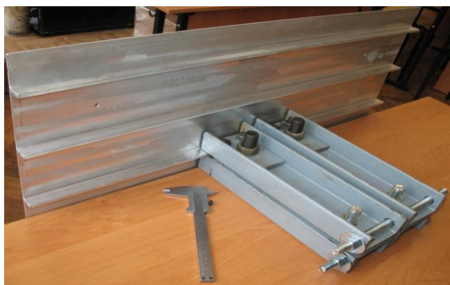
Рис. 4 – Внешний вид механического устройства для правки и доводки панелей с ребрением
