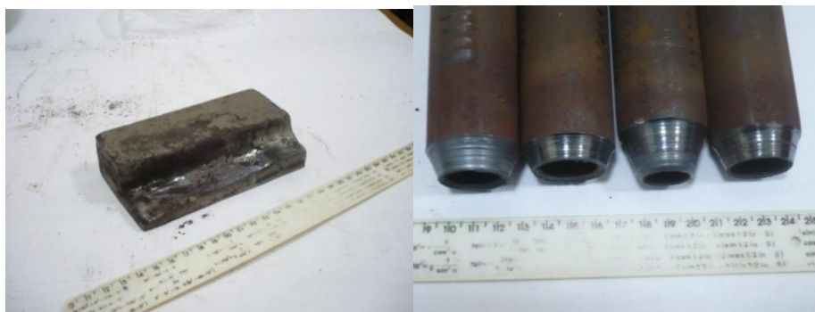
Рис. 7 – Экспериментальные исследования: а – инструмент переменного профиля, б – вид заготовок после обкатки
