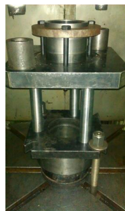
Рис. 10 – Фотографія матриці спеціального профілю, яка розміщена на проміжній плиті штампа для витягування
