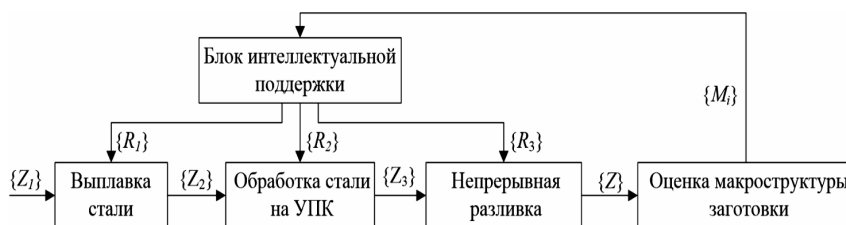
Рис. 2. Схема многостадийного производства непрерывно-литой заготовки
