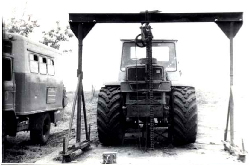
Рисунок 3 - Установка для исследования свободных колебаний трактора.
