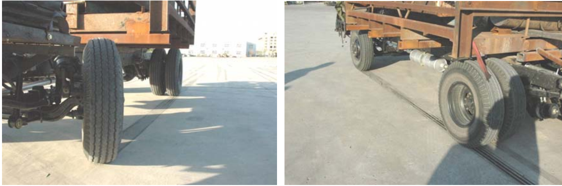
Рисунок 3 – Результати гальмових випробувань шасі автобуса А074: а – кермовий механізм з однією поздовжньою тягою; б – кермовий механізм з двома поздовжніми тягами
