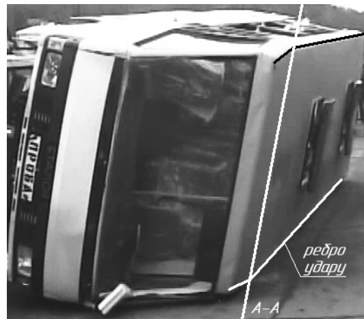
Рисунок 7 - Представлення особливостей сприйняття удару ребром ферми даху
