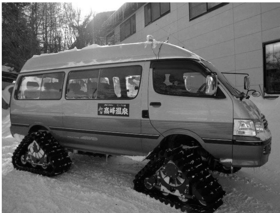
Рисунок 5 – Микроавтобус Toyota с гусеничными треугольными блоками вместо колес [4].
