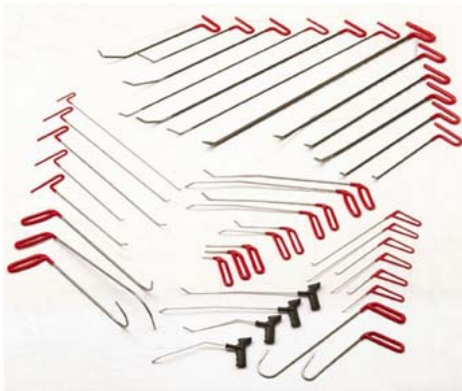
Рисунок 1 – Специальный инструмент (крючки) для выравнивания внутренних повреждений элементов кузова автомобиля
