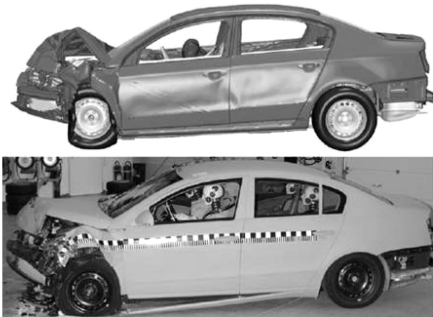
Рисунок 2 - Сравнительный анализ разрушений автомобиля, выполненный компанией Volkswagen.
