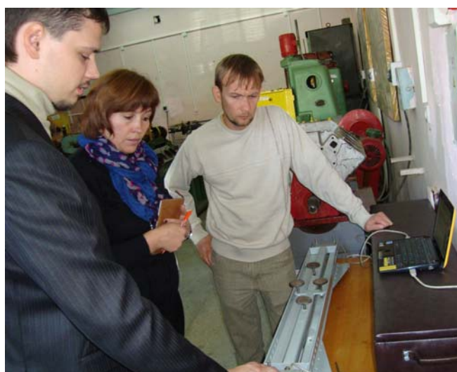
Рисунок 2 – Проведение процесса градуировки датчиков ускорений: а – процесс градуировки датчиков ускорений Freescale Semiconductor на тарировочном устройстве в лаборатории; б – процесс градуировки датчиков ускорений перед испытаниями эксплуатационных свойств седельного тягача Краз-6444
