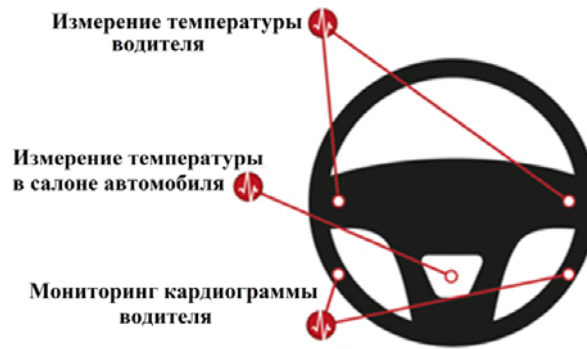
Рисунок 1 – Схема размещения датчиков многофакторной системы на рулевом колесе
