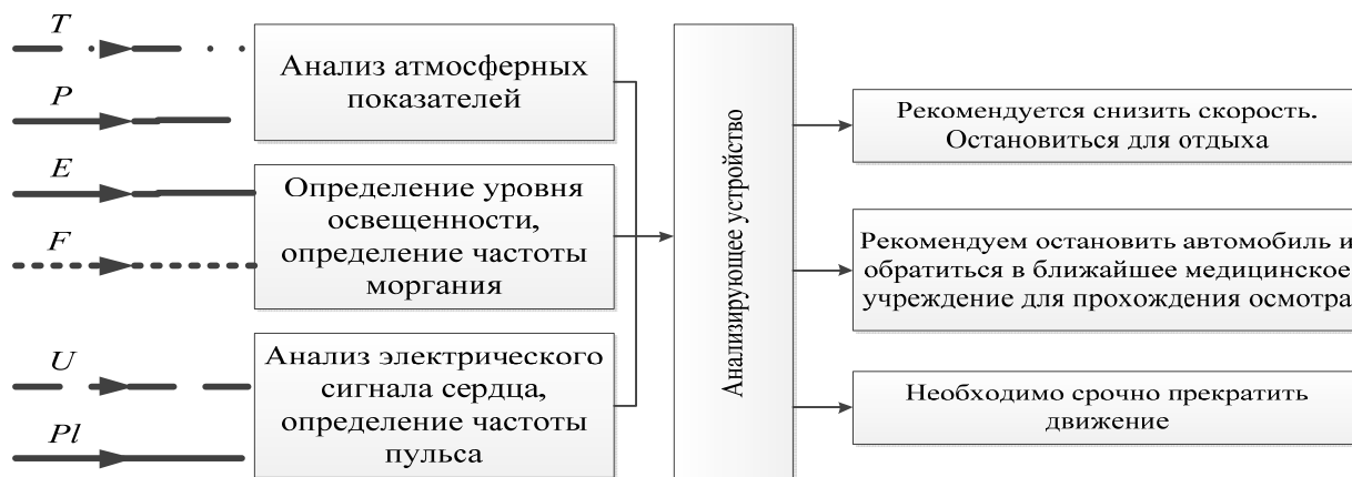
Рисунок 5 – Структурная схема работы системы
