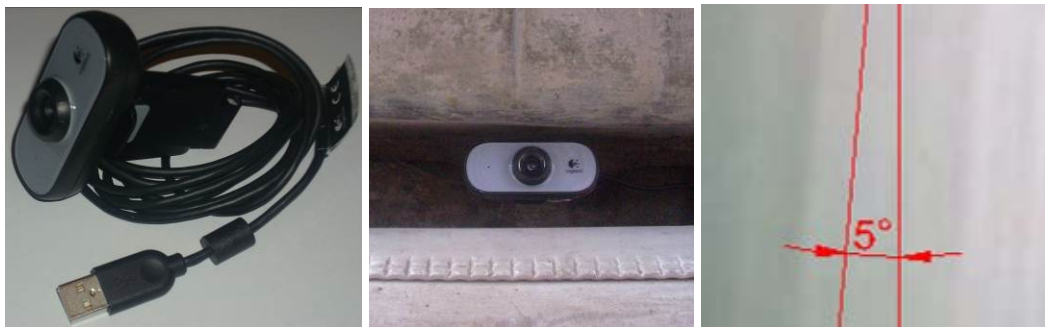
Рисунок 3 – Розміщення відеокамери на автомобілі та фрагмент запису кута відведення осі автомобіля
