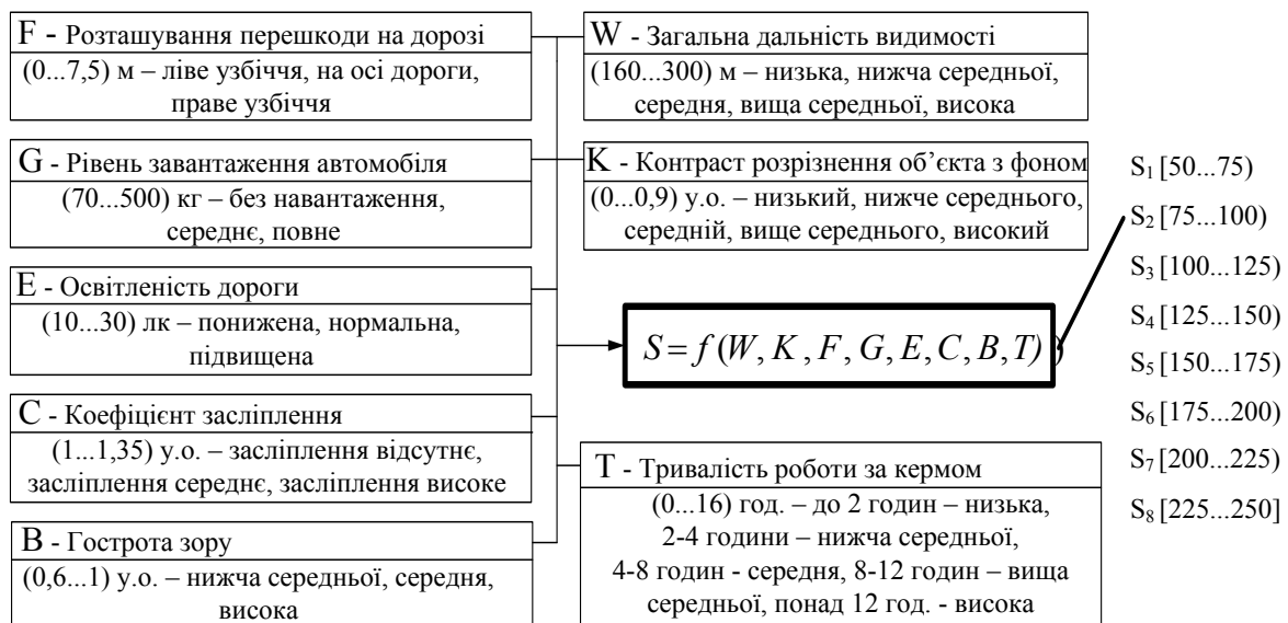
Рисунок 2 – Структура моделі визначення дальності видимості (фактори впливу, універсальна множина та терми для їх оцінок)
