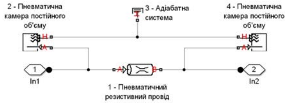
Рисунок 4 – Simscape модель пневмопроводів під маскою (поз. 7, 9, рис. 2)
