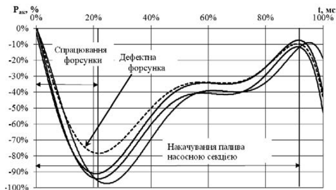
Рисунок 3 – Змодельована несправність однієї з форсунок
