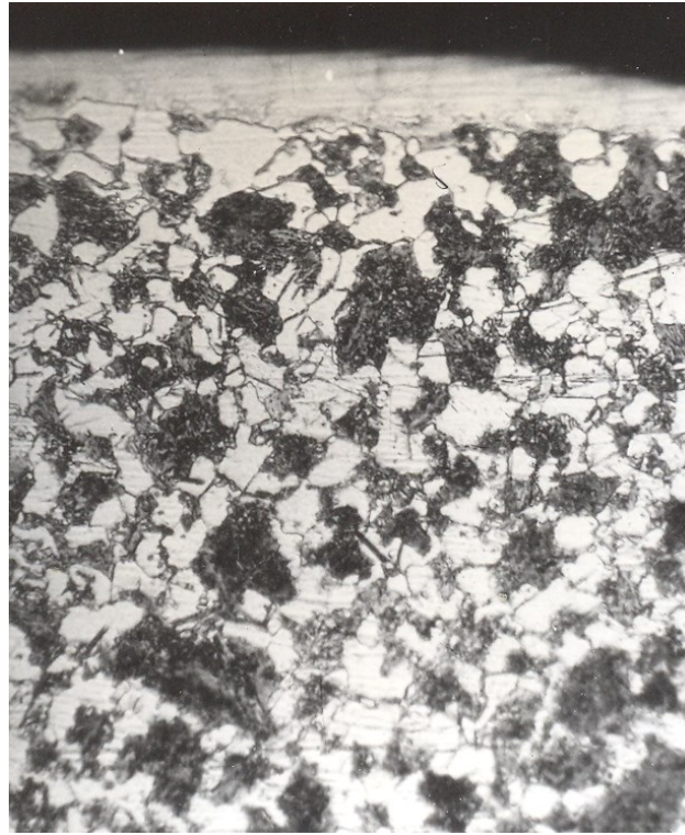
Рисунок 1 – Микроструктура оксикарбонітрированого слоя стали 45 штока амортизатора.
