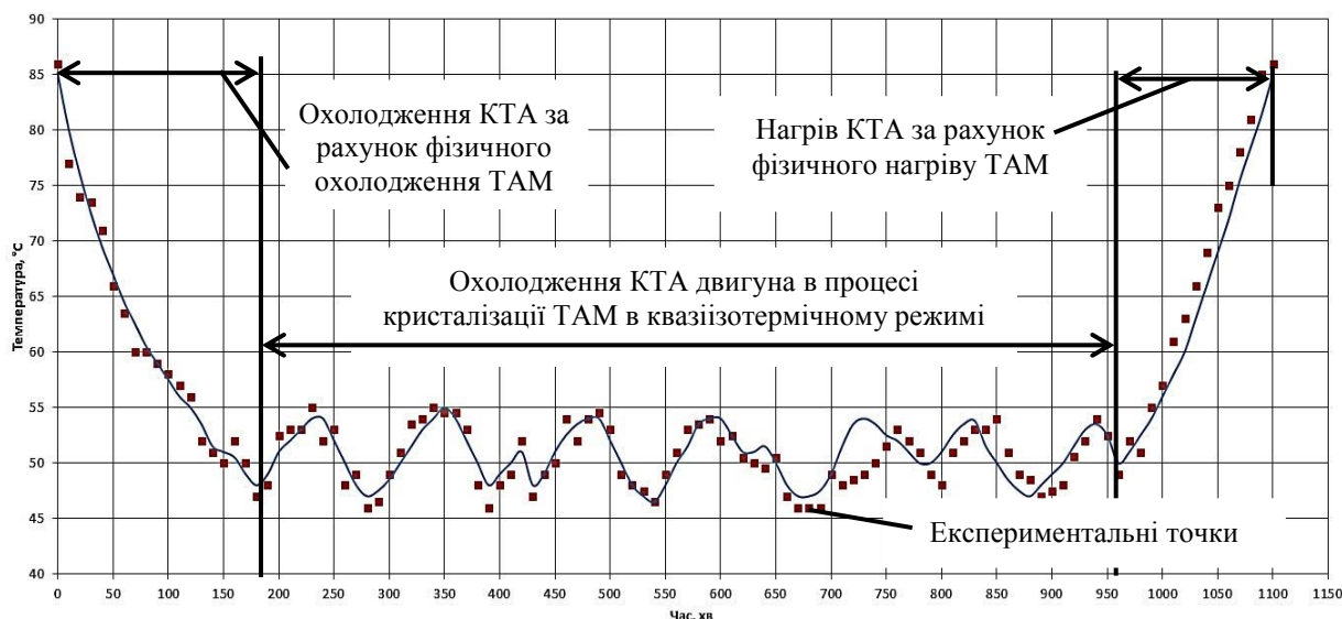
Рисунок 2 – Динаміка зміни температури ТАМ в КТА у складі КСКП для двигуна ТЗ і ЕУ за цикл роботи (розрядки-зберігання теплоти-зарядки) при T_{OC}=20\text{ }^{\circ}\text{C}
