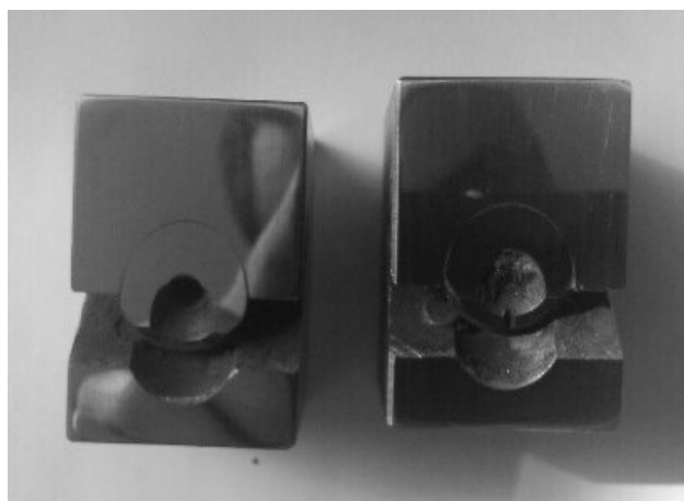
Рисунок 3 – Зразкотримач для виготовлення шліфа.
