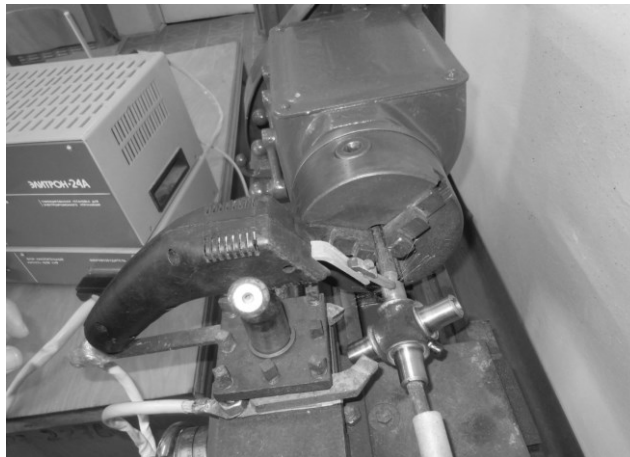
Рисунок 2 – Процес нанесення покриття електроіскровим методом на шип хрестовини карданного валу.
