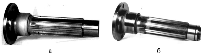
Рисунок 3 – Вал привода переднего моста трактора Т-150К с покрытием шейки ПГ-10Н-01: а – после напыления; б – после шлифовки
