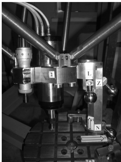
Рис. 1 – Встановлення пневмошпинделя на рухомій платформі верстата з паралельними кінематичними структурами
