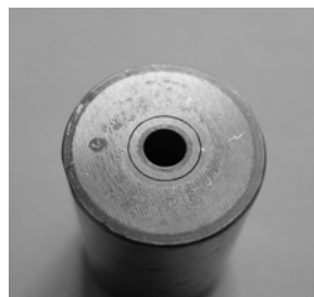
Рис. 11 – Торцевая поверхность ползуна с запрессованной втулкой из стали ХВГ после 100000 циклов срабатывания клапана
