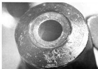
Рис. 2 – Повреждения верхней торцевой поверхности ползуна (якоря) под действием циклических ударных нагрузок во время открытия клапана (формоизменение поверхности по месту контакта со стопорной шайбой и выкрашивание поверхности по месту контакта с верхним стопом)
