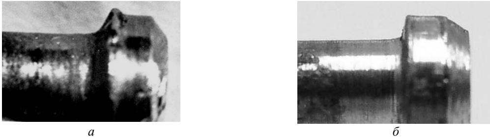
Рис. 9 – Вид головки штока ЭМК после ресурсных испытаний: а – подвижная система электромагнитного привода без демпфирующего элемента, наработка 20000 циклов; б – подвижная система электромагнитного привода с демпфирующим устройством, наработка 1000000 циклов
