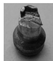
Рис. 6 – Усталостное разрушение шейки штока
