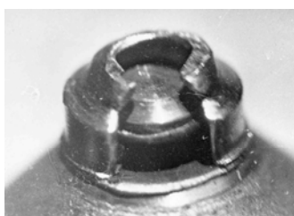
Рис. 4 – Узел крепления штока и ползуна после наработки 200000 циклов срабатывания
