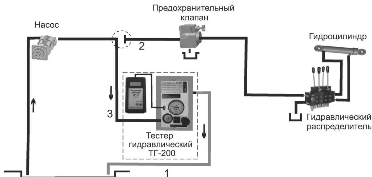
Рис. 2 – Схема тестирования насоса
