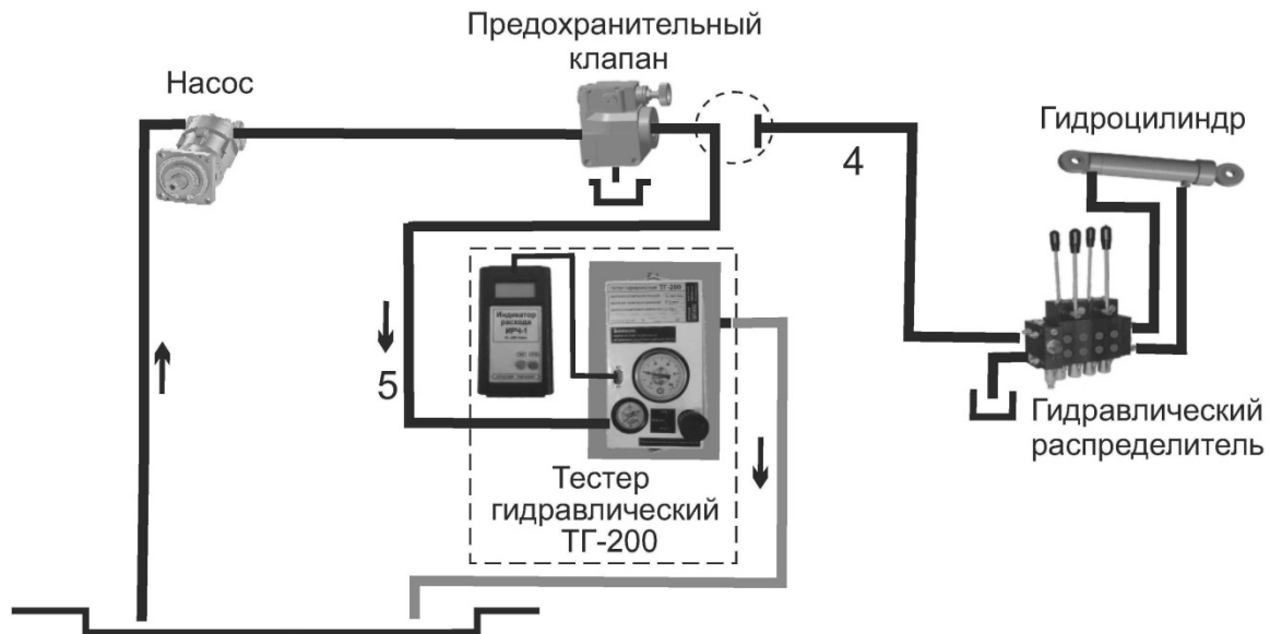
Рис.4 – Схема тестирования предохранительного клапана
