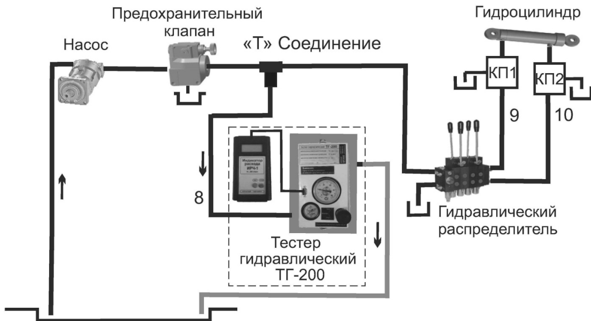
Рис. 6 – Тестирование "Т" соединения
