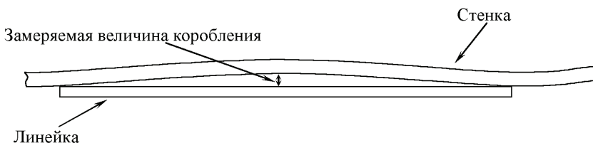
Рисунок 8 – Схема измерения коробления
