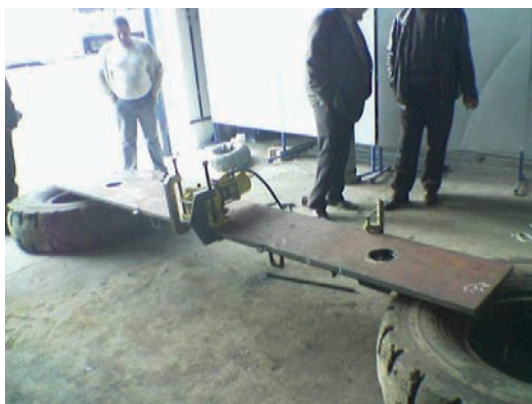
Рисунок 3 – Расположение конструкции с закрепленным вибратором на опорах
