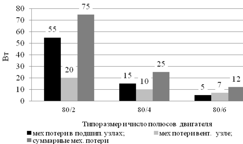
Рис.5 – Усредненные данные разделения потерь в подшипниковых и вентиляционных узлах АИР 80А с числом пар полюсов 2p=2,4,6 .
