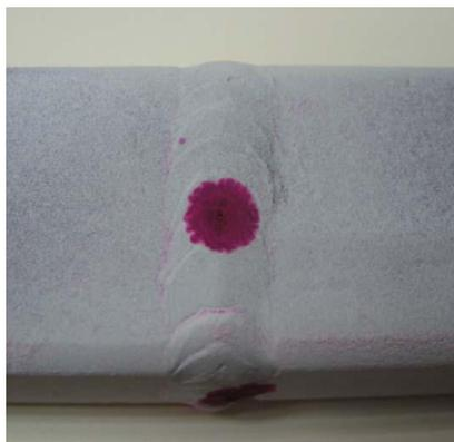
Рис. 3. Круглая индикация в сварном шве от дефекта типа пора
