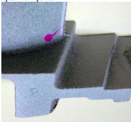
Рис. 2. Индикация от дефекта типа трещина на лопатке турбины
