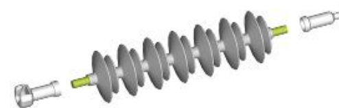
Рис. 3 - Цельнолитая конструкция полимерного изолятора
