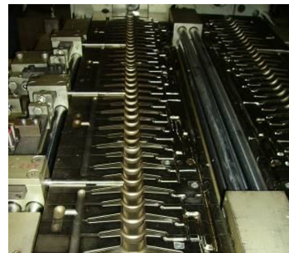
Рис. 7- Нижняя половина литьевой формы для литья кремнийорганических оболочек линейных изоляторов с тремя технологическими упорами
