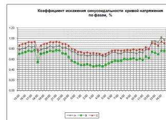
Рис. 6 – Коэффициент искажения синусоидальности кривой напряжения по фазам
