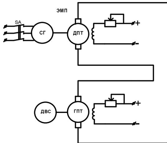
Рис 1 – Схема подключения тормозных стендов к электромашинному преобразователю.
