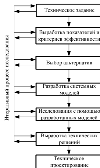
Рис. 1. Алгоритм инженерного синтеза сложной системы
