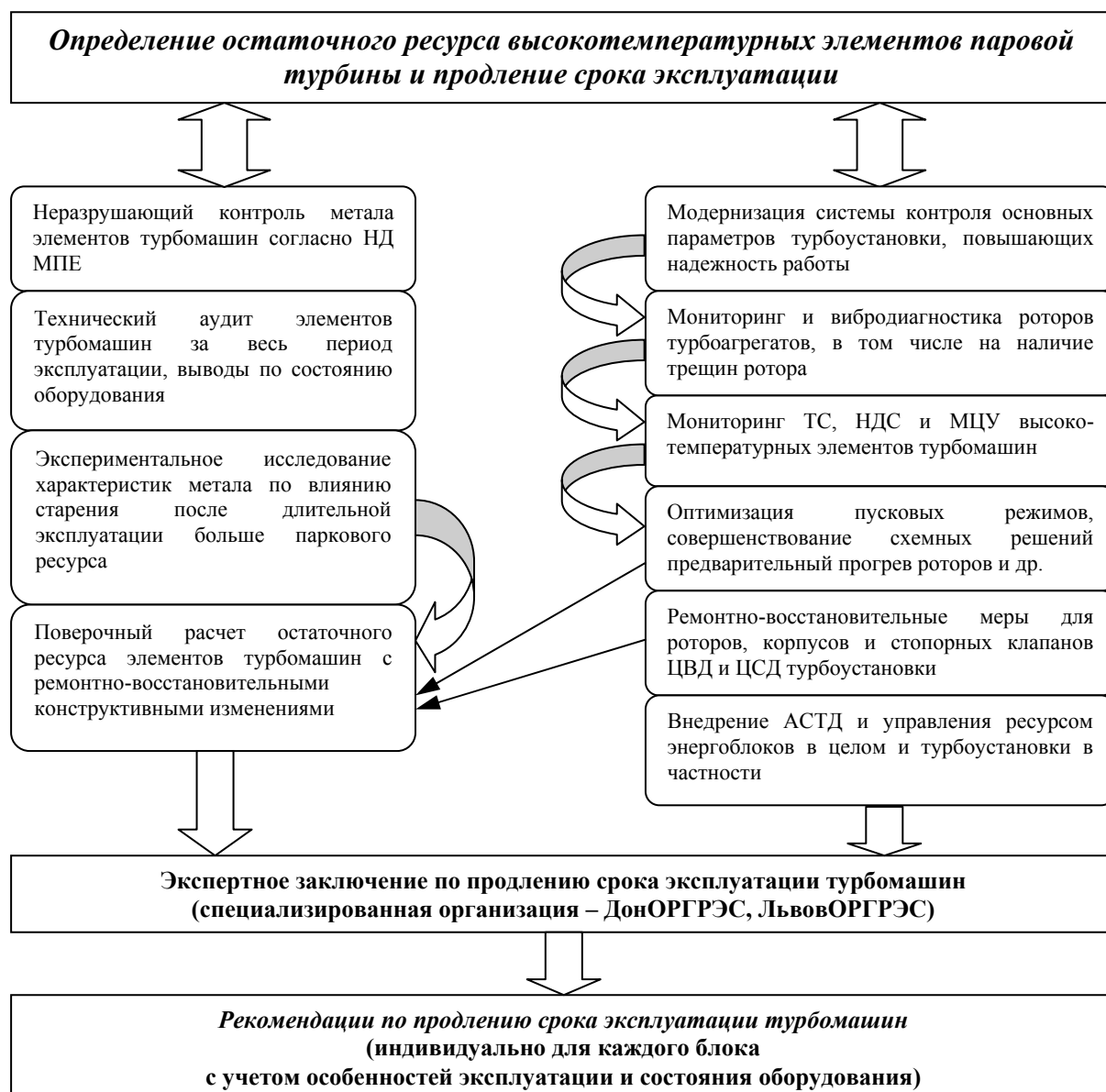
Рис. 1. Комплексная схема определения остаточного ресурса элементов паровой турбины и продления срока их эксплуатации
