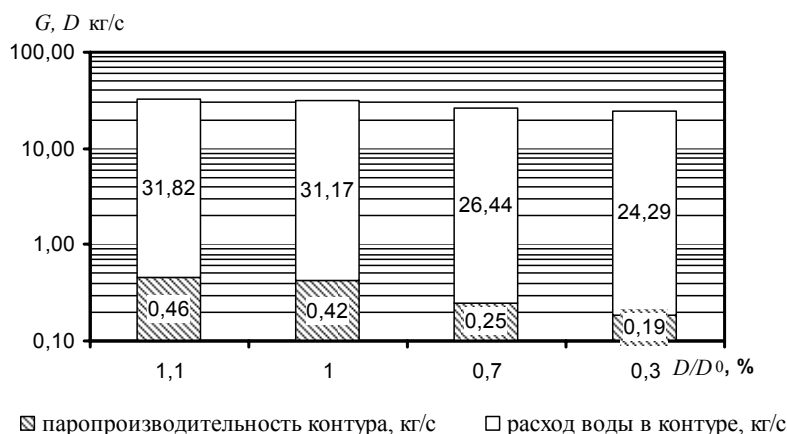
Рис. 2. Соотношение расходов пара и воды в контуре
