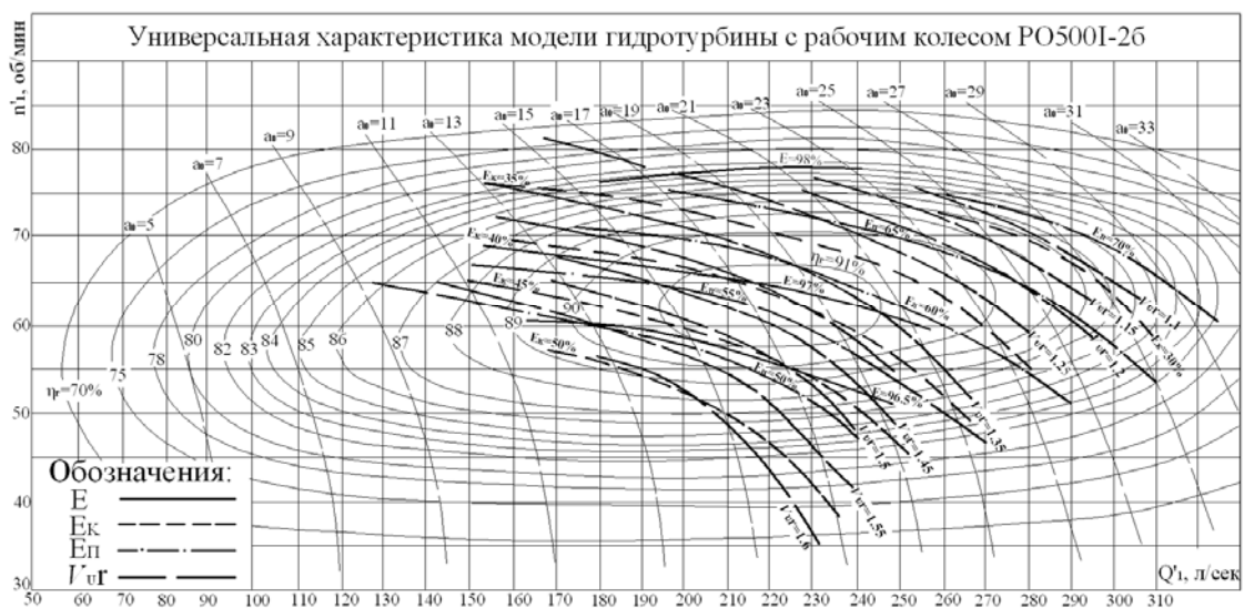
Рис. 7 – Параметры потока перед рабочим колесом на различных режимах
