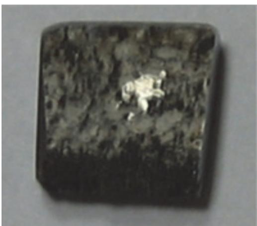
Рис. 6 – Экспериментальный образец из лопаточного материала с противоэрозионным защитным покрытием, нанесенным методом электроискрового упрочнения
