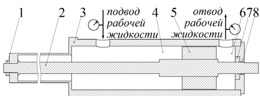
Рис. 2 – Схема испытательного узла: 1 – гайка; 2 – вал; 3 – корпус; 4 – камера перед уплотнением; 5 – втулка; 6 – камера после уплотнения; 7 – уплотняющая манжета; 8 – крышка
