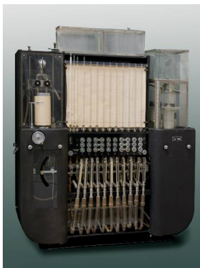
Рис. 5. Гідроінтегратор В. С. Лук'янова ІГ-3
