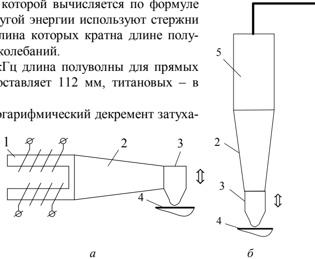
Рис. 1 – Принципиальные схемы устройств для ультразвуковой обработки: а – используются поперечные; б – продольные колебания; 1 – электромагнитный генератор; 2 – волновод; 3 – индентор; 4 – обрабатываемая поверхность; 5 – пьезокварцевый или магнитоотрицательный элемент.
