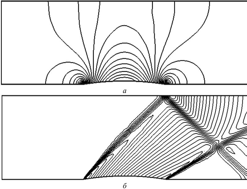
Рис. 4 – Изолинии коэффициента давления в канале:
