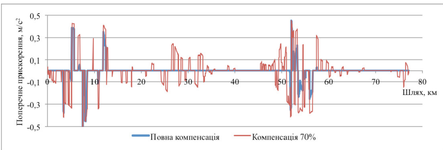
Рис. 4 – Поперечне прискорення, що зазнає кузов при використанні активної системи нахилу до 6^\circ .
