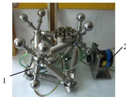
Рис. 12 – Установка 1 для визначення динамічних характеристик просторової системи приводів із пристроєм 2 для синусоїдального навантаження.
