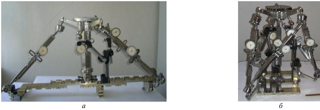
Рис. 6 – Макетні зразки просторових систем приводів, оснащені контрольно-вимірювальною апаратурою: а – механізм-трипод; б – механізм-гексапод.
