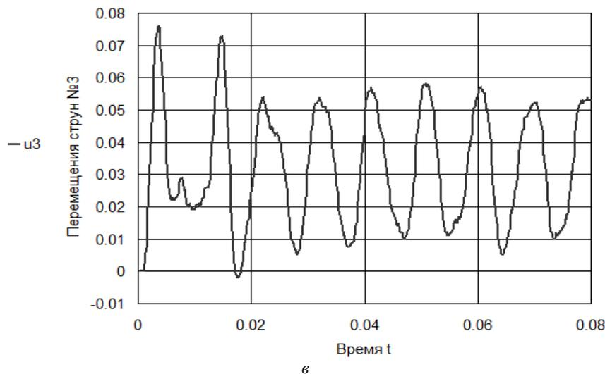
Рис. 3 – Перемещения струн под действием сосредоточенной нагрузки:  $v$  – струны № 3.
