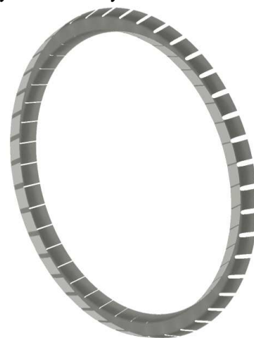
Рис. 14 – Лепестковая пружина для манжеты большого диаметра.
