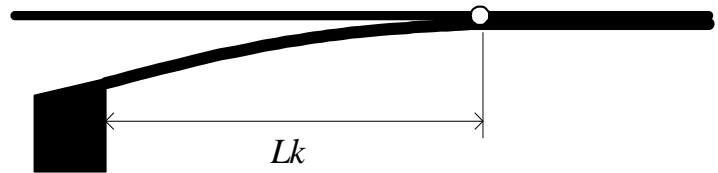
Рис. 7 – Тонкий ус имеет контактную зону цилиндрической формы.
