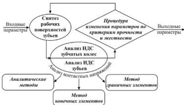
Рис.1. Схема синтеза двухпараметрической передачи по кинематическим и прочностным критериям
